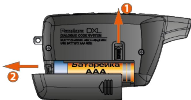
виброизвещатель. Для замены элемента питания: • Сдвиньте фиксатор крышки батарейного отсека в направлении, указанном стрелкой 1; • Сдвиньте крышку батарейного отсека в направлении, указанном стрелкой 2; • Извлеките элемент питания из батарейного отсека и установите новый; • Брелок готов к работе (включите его нажатием кнопки в течение 3 секунд). **Рекомендуем иметь в автомобиле запасную батарейку AAA.**
