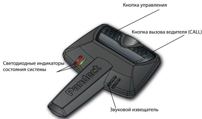
Функционал иммобилайзера реализован в RF-модуле системы. RF-модуль взаимодействует с противорабобными метками и радиоуправляемыми реле блокировки на частоте 2,4 ГГц. Изменение настроек иммобилайзера, программирование реле и меток производится в меню программирования RF-модуля. Для аварийной деактивации и входа в режим программирования иммобилайзера используется секретный PIN-код.
