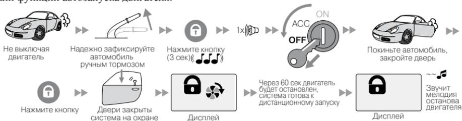
Если разрешен подуровень II-3.8 «Автоматическое включение программной нейтрали», то процедура «программная нейтраль» будет автоматически выполняться при поднятии ручника. Неисполнение процедуры «программная нейтраль» влечет за собой отказ системы выполнять команды дистанционного и автоматического старта двигателя.
