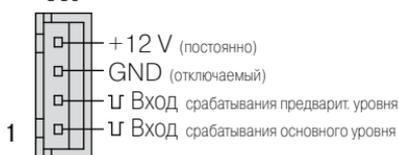
Входы обрабатывают импульсы отрицательной полярности длительностью не менее 0,3 сек
