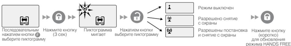
Для сохранения настройки коротко нажмите на кнопку «1», при этом настройки будут переданы в базовый блок, при этом вы услышите короткий сигнал сирены.
