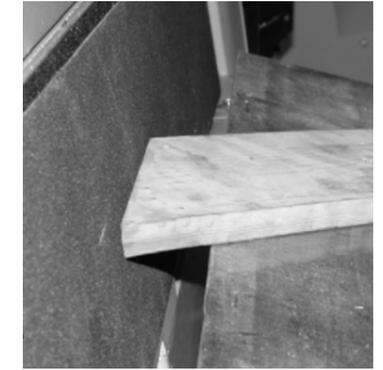
Рабочий стол установлен под необходимым углом к шлифовальной ленте, заготовка опирается на рабочий стол и угловой упор. Угловой упор установлен на необходимый угол.
