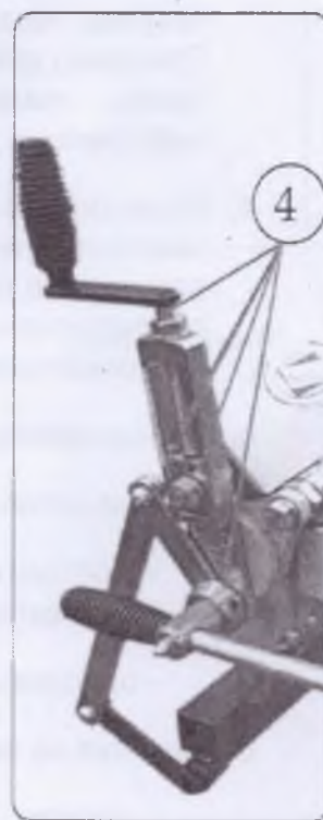
4 Смазывание подвижных точек механизма поднимания нажимной балки - типа загибание листа с четырех сторон (масленка)
