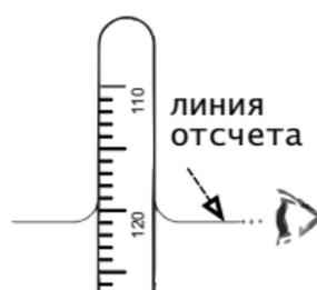
Если измерение плотности электролита производилось при разных температурах, пересчитайте значение плотности используя поправку. См. рис. 2.
