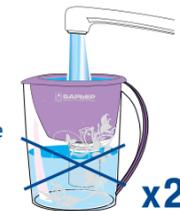
**4** В процессе использования также возможно попадание частиц угля в отфильтрованную воду. Это безопасно для здоровья и не свидетельствует о неисправности сменной кассеты.
