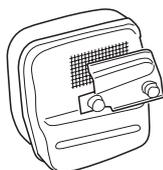
Если на вашем инструменте стоит глушитель такого типа, то сетку следует очищать не реже одного раза в неделю. На глушителях с катализатором, такую очистку достаточно производить раз в месяц. При возникновении повреждений на сетке ее следует заменить.
