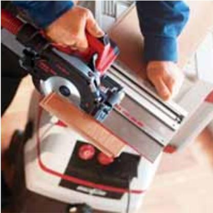
Стационарное соединение быстро запирающим механизмом погружной пилы и торцовочной шины – в результате получилась многофункциональная система для косых и наклонных резов.
