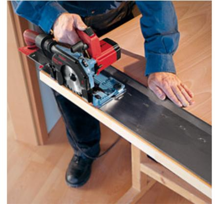
Комбинация с направляющей гибкой шиной - рез с высокой степенью точности до 1,4 м.
