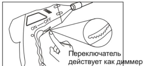
4. Аккуратно направьте трубку в нужное место. Небольшие корректировки могут быть сделаны перемещением головки в прямом направлении.
