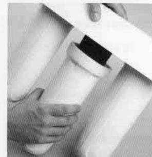
Раскрутить входящим в комплект поставки ключом второй корпус и вывернуть картридж. Вылить из него воду. Очистить внешнюю поверхность картриджа мягкой щеткой (например, платяной) под струей воды.
