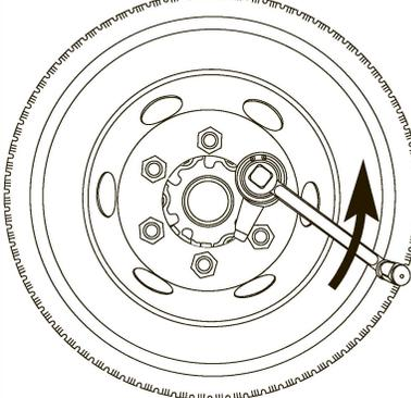
Установить гайковёрт с присоединительной головкой и зафиксировать его положение с помощью рычага. Откручивание гайки крепления диска колеса производить вращением ручки против часовой стрелки. При снижении усилия откручивания гайки использовать удлинитель для ускорения процесса снятия колеса.
