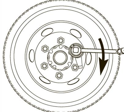
Использовать удлинитель для ускорения процесса установки колеса. Для окончательной затяжки гайки установить гайковёрт с присоединительной головкой и зафиксировать его положение с помощью рычага. Закручивание гайки крепления диска колеса производить вращением ручки по часовой стрелке.
