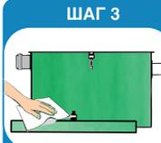
Убедиться в целостности патрубков, внутренних перегородок и уплотнителя крышки жиροуловителя\*. Включить подачу воды до полного заполнения жиροуловителя до рабочего уровня
