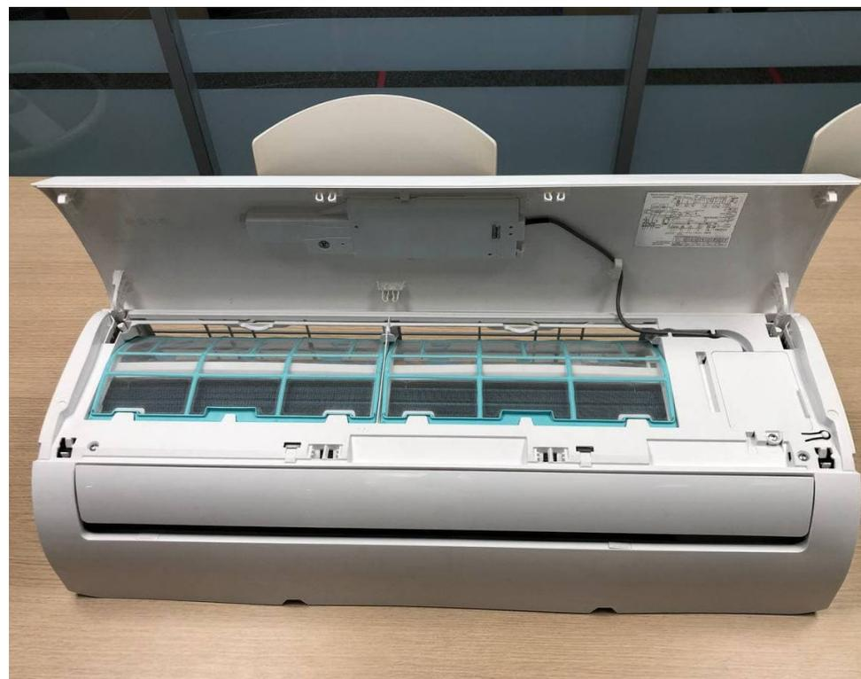
3. Крестовой отверткой PH2 открутите винт крепления защитной крышки клеммников.
