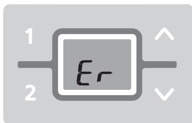
Проточный водонагреватель является надежным изделием, прошедшим многоступенчатую процедуру контроля качества перед отгрузкой покупателю. Тем не менее, возможность возникновения мелких неисправностей не исключается. В этом случае сначала выключите и включите предохранитель для перезапуска электроники. Затем попытайтесь устранить проблему с помощью следующей таблицы. Это позволит избежать ненужных расходов, связанных с вызовом специалиста.
