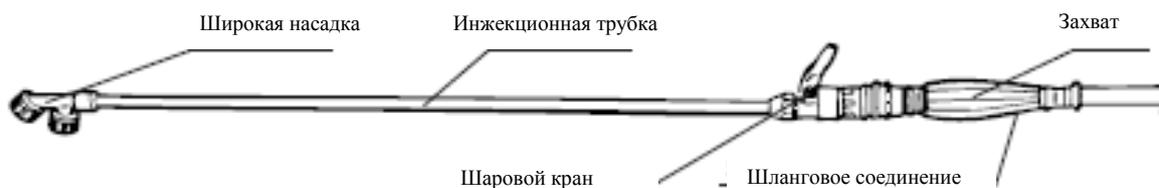
После проверки уплотнения надежно прикрепите инъекционную трубку к захвату, а широкую насадку к инъекционной трубке. Данную процедуру необходимо проделать для проверки устройства на наличие утечек воды. Перетяжение, тем не менее, может вызвать экструзию или повреждение уплотнения, поэтому правильное давление затяга очень важно в данном случае.
