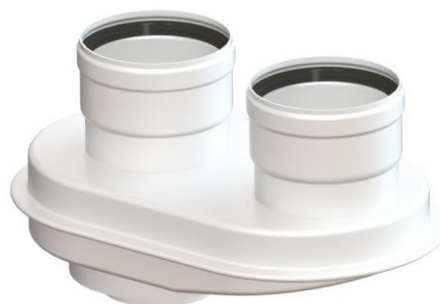
Рис. 5. Переходник с коаксиальной системы дымоудаления \varnothing 60/100 мм на отдельную \varnothing 80/80 мм. Перед тем как приступить к выполнению монтажа, проверьте правильность используемой диафрагмы и то, что воздуховод и дымоход не превышают максимально допустимой длины, используя для этого простой расчет:
