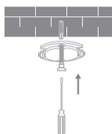
4. Совместите пазы в нижней части камеры с выступающей частью на подставке электропитания, а затем поверните ее по часовой стрелке, пока она не зафиксируется на месте.
