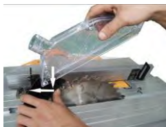
Рис.5 Установка защитного кожуха диска
