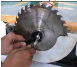
Рис.7. Снятие пильного диска
