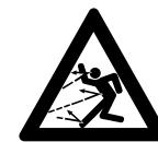
Никогда не направлять воздушную струю в сторону других людей либо животных – агрегат может подбрасывать небольшие предметы с большой скоростью – **опасность получения травм!**
