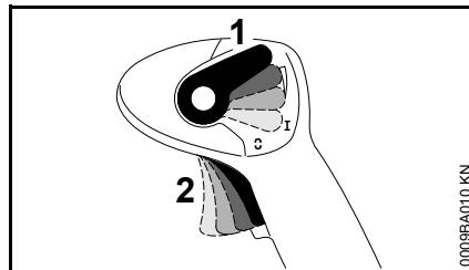
Рычаг газа (2) может бесступенчато фиксироваться посредством приведения в действие установочного рычага (1):
