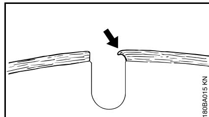
При продолжении работы затупившимися сегментами последние могут размягчиться, вследствие значительного тепловыделения – основное полотно раскаляется и теряет свою твердость – это может привести к деформациям, явно распознаваемым по качению абразивно-отрезного круга.
