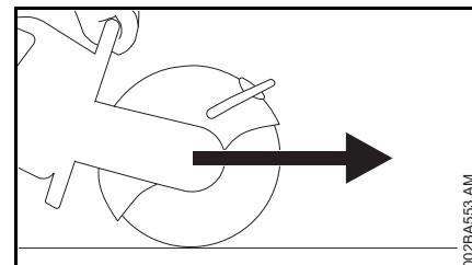
Если абразивно-отрезной круг касается разрезаемого предмета сверху, то абразивно-отрезное устройство оттягивается от пользователя вперед..
