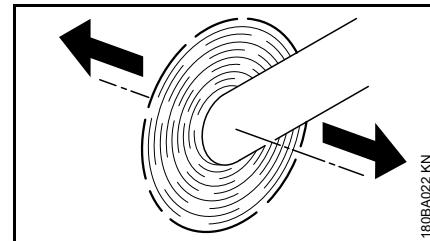
Если абразивно-отрезное устройство при вращающемся абразивно-отрезном круге перемещается в направлении, указанном стрелкой, то возникает сила, которая пытается опрокинуть агрегат.
