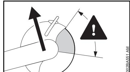
При обратной отдаче (Kickback) абразивно-отрезное устройство неожиданно отбрасывается в сторону пользователя, выходя из-под контроля.
