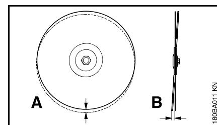
Слишком сильное отклонение от допуска на радиальное биение (A) перегружает отдельные алмазные сегменты, которые, при этом, нагреваются. Это может вызвать возникновение трещин в основном полотне или расплавление отдельных сегментов.
