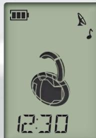
**i** Если выполнены необходимые подключения для реализации функции отпирания дверей в 2 этапа, то при снятии системы с охраны будет отпираться только дверь водителя. Для отпирания всех остальных дверей автомобиля необходимо нажать и отпустить кнопку снятия с охраны еще раз.
