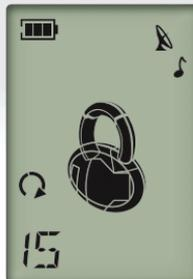
**I** Во время работы двигателя Вы можете посмотреть текущее время. Для этого нажмите кнопку **F** 5-кнопочного передатчика. Индикация текущего времени включится на 3 секунды и затем опять продолжится индикация обратного отсчета времени работы двигателя.
