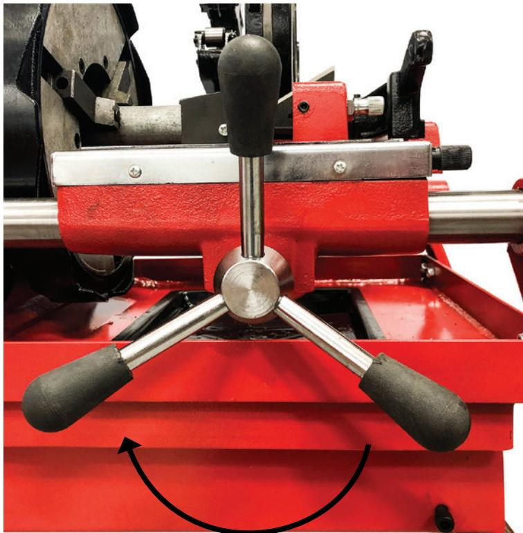
Опустите труборез на обрабатываемую деталь и включите станок выключателем.
