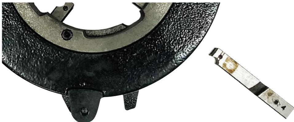
Таким же образом вставляем все ножи. Рычаг поворачиваем по часовой стрелке, фиксируем его и ставим резьбонарезную головку на место.
