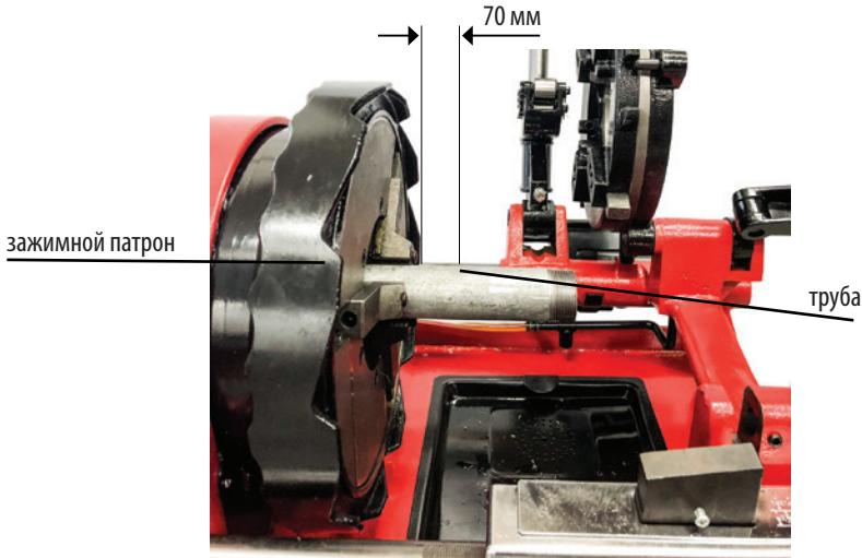
Поднимите труборез (1), резьбонарезную головку(2) и гратосниматель (3) так, чтобы они не мешали. Введите обрабатываемую деталь через центрирующий зажимной патрон (7) и затяните его.
