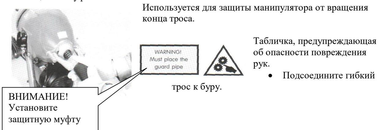
Вставьте бур в 67° паз на тросе до полного соединения. Это позволяет сделать соединение более надежным, простым и быстрым.
