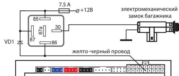
В этой схеме для открывания багажника используется доп. канал №1 (желто-черный провод разъема X1). При подключении необходимо использовать дополнительное реле, а программируемую функцию 14 настроить в вариант 1 (см. стр. 42).
