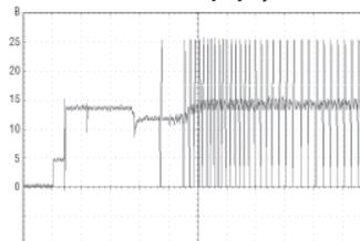
В качестве сигнала, пропорционального скорости вращения двигателя, также может быть взят сигнал от цепи управления форсунками. В большинстве случаев он позволяет надежно определять состояние работающего двигателя.
