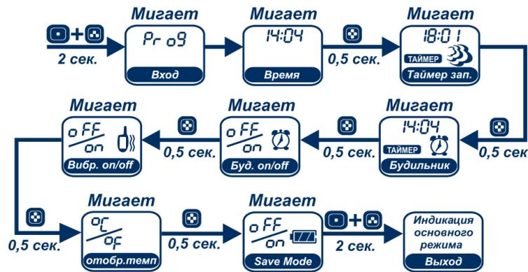
Кнопка **1** осуществляет перемещение по меню брелока, кнопка **+** возвращает к предыдущему пункту меню. В режимах установок часов, таймера запуска и будильника нажатие кнопки **1** изменяет значение часов, нажатие кнопки **+** изменяет значение минут. Удержание данных кнопок приводит к быстрой перемотке значений. Нажатием кнопки **+** последовательно изменяется текущее состояние функций on - off - on.
