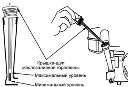
Рис. 7 Проверка уровня масла в картере
