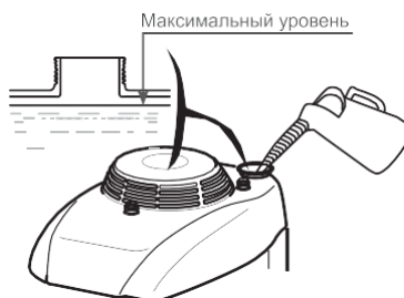
Рис. 5 Максимальный уровень топлива
