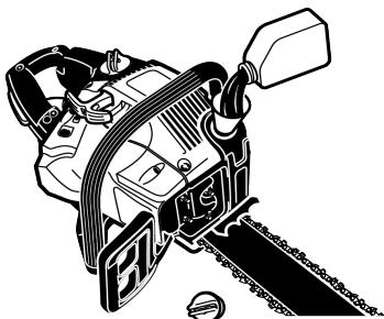
Пользуйтесь маслом марки соответствующей пиле для смазки пильных шин и цепей. Масло этой марки, специально предназначенное для смазки пильных цепей, применяется в широком температурном диапазоне без необходимости его разжижения. Для смазки цепи требуется примерно один бачок масла на один бачок топлива.
