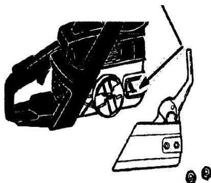
3. Используя отвертку, поверните винт натяжения цепи пока штифт натяжителя цепи не переместится в ближнее к ведущей звездочки положение.
