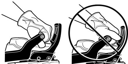
При работающем моторе держите пилу как можно крепче. Большой палец должен придерживать рукоятку снизу, а остальные пальцы — охватывать ее по окружности. Такой захват最难ен всего нарушить (в результате отбрасывания пилы назад или иной внезапной её реакции). Любой другой захват, при котором большой и остальные пальцы оказываются по одну сторону рукоятки, опасен, ибо чреват потерей управления пилой при малейшем ее отскоке.
