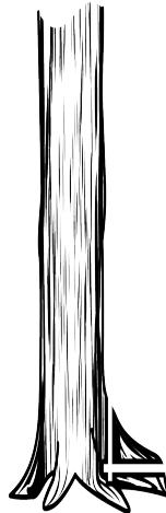
Сначала пропилите опорный корень в горизонтальном направлении, затем — в вертикальном. Уберите отпиленное с места проведения работ. После того, как мощные опорные корни будут отпилены, выполните порядок действий при валке дерева. См. выше раздел «Эксплуатация — Порядок действий при валке деревьев».
