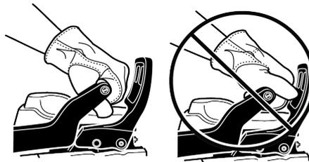
При работающем моторе держите пилу как можно крепче. Большой палец должен придерживать рукоятку снизу, а остальные пальцы — охватывать ее по окружности. Такой захват труднее всего нарушить (в результате отбрасывания пилы назад или иной внезапной её реакции). Любой другой захват, при котором большой и остальные пальцы оказываются по одну сторону рукоятки, опасен, ибо чреват потерей управления пилой при малейшем ее отскоке.
