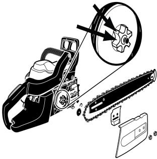
повреждения. При обнаружении признаков износа или повреждения на указанных стрелками участках обратитесь в сервис-центр компании для замены зубчатого колеса.
