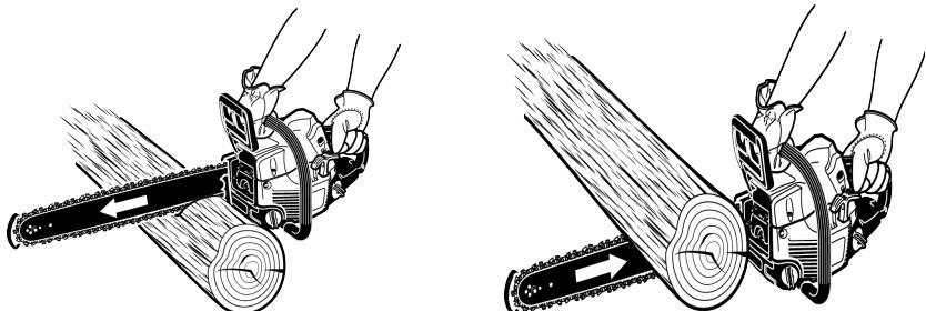
4. Оставьте мотор работать на полных оборотах в течение всего времени пилки.
