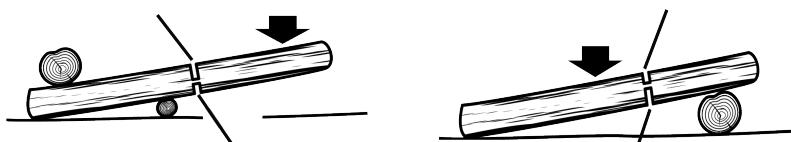
Во избежание защемления пильной шины и цепи внимательно следите за механическим напряжением бревна.
