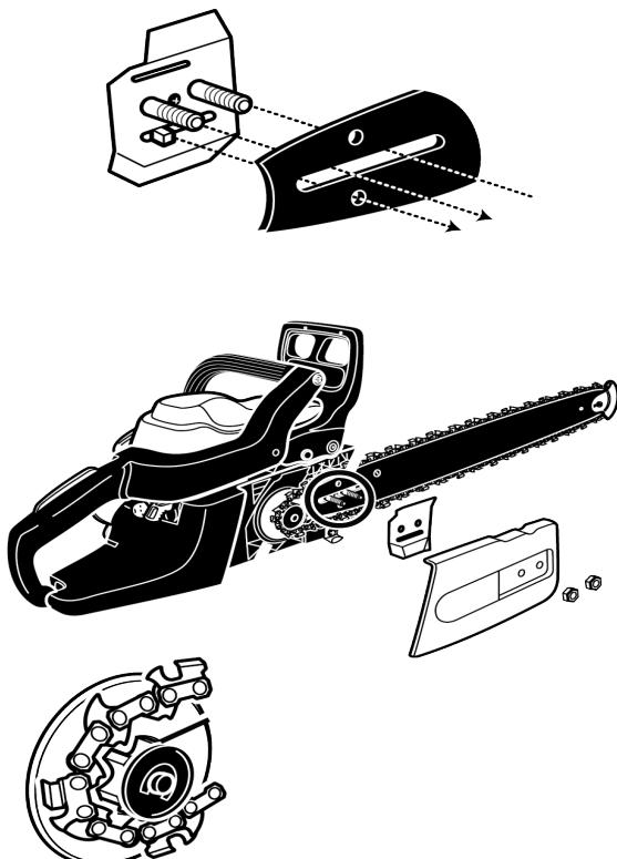
5. Расположите цепь на шину , ориентируя что бы режущие кромки смотрели по часовой стрелке.
