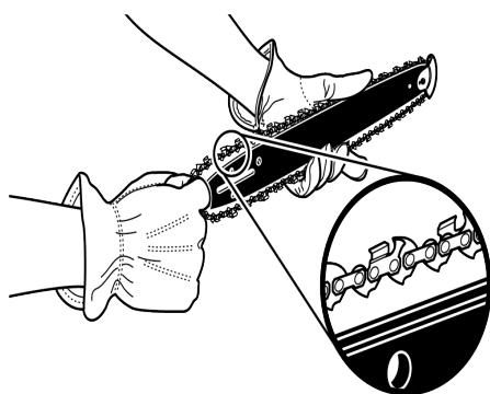
8. Установите крышку шины, проверяя что бы цепь не выпала из паза шины, следите за тем чтобы штифт натяжителя точно вошел в соответствующее отверстие в шине, наживите и закрутите **не затягивая тугоС гайки крышки**.
