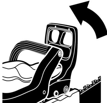
2. Удалите гайки крепления крышки шины.
