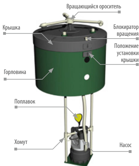
Рисунок 17. Установка циркуляционного насоса Станции.
