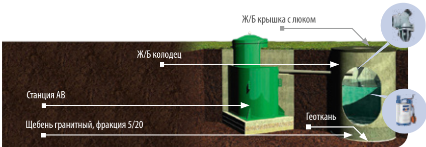
Рисунок 7. Система поглощения, колодец поглощения.
