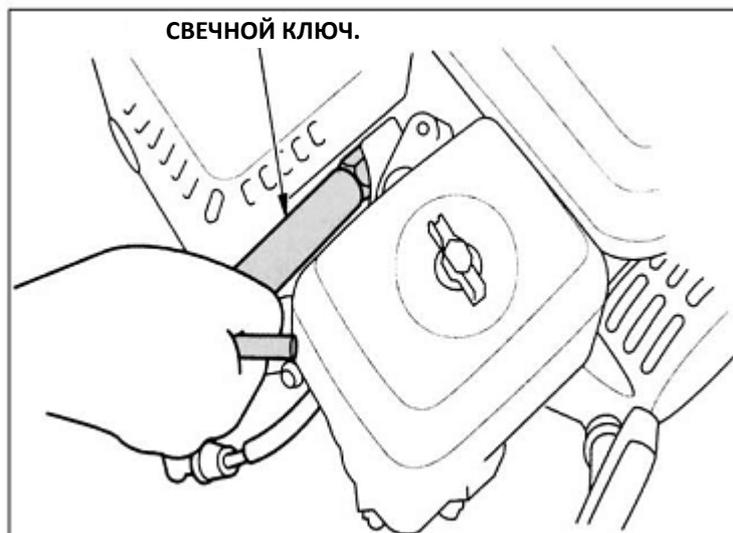
3. Проверить исправность свечи зажигания. Произвести замену свечи в случае износа электродов свечи или при наличии трещин или сколов на изоляторе.
