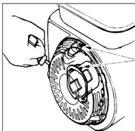
Совместить зубец на шкиве пускателя с отверстием в верхней части крышки пускателя.
