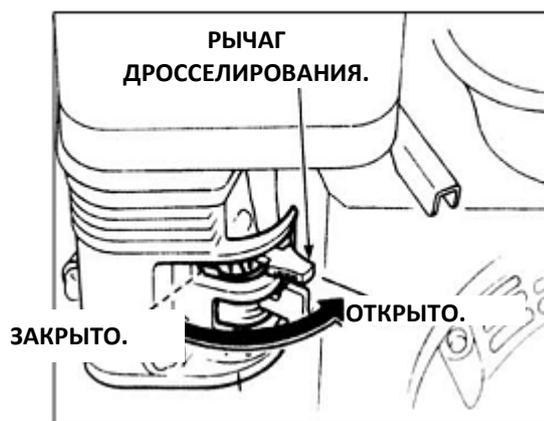
**4.8. РЕГУЛИРОВКА ЧИСЛА ОБОРОТОВ ДВИГАТЕЛЯ.**
