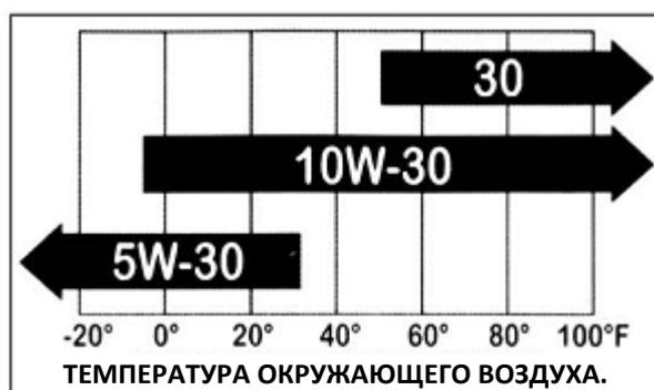
Информация по вязкости масла SAE и категории обслуживания указана в табличке API на масляной емкости. Производитель рекомендует использование масла категории SJ или SL в соответствии со стандартом API Service.
