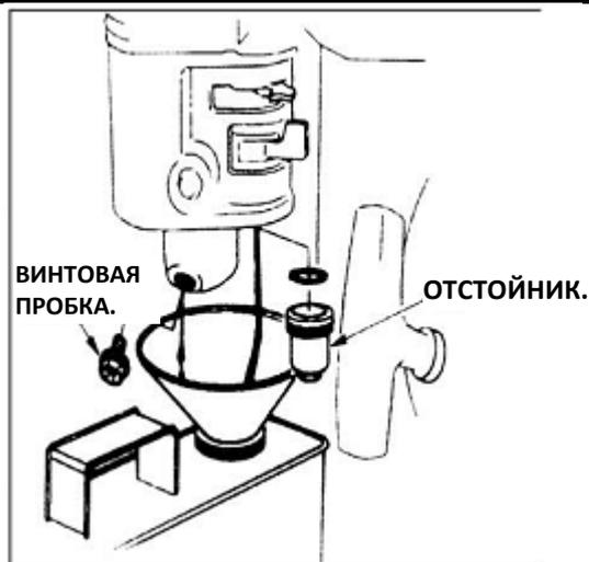
3. После слива всего топлива в канистру установить на прежнее место и плотно затянуть винтовую пробку и отстойник.
