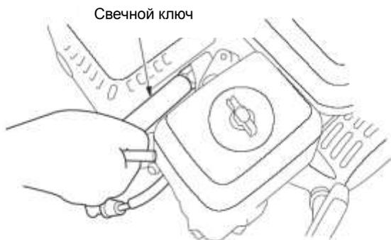
3. Осмотрите свечу зажигания. Замените ее, если электроды изношены или если треснут или поврежден изолятор.
