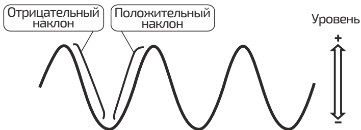
Рисунок 6. Иллюстрация полярности (фронтов) запуска синхронизации.
