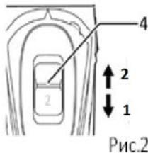
**ВНИМАНИЕ!** Запрещается пользоваться механическим переключателем скорости при работающем инструменте. Дождитесь полной остановки двигателя!
