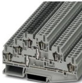
Многоярусный клеммный модуль, с потенциальным разъемом, Тип подключения: Пружинный зажим, Сечение: 0,08 мм<sup>2</sup> - 4 мм<sup>2</sup>, AWG: 28 - 12, Ширина: 5,2 мм, Цвет: серый, Тип монтажа: NS 35/7,5, NS 35/15
