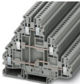
Многоярусный клеммный модуль, Тип подключения: Винтовые зажимы, Сечение: 0,14 мм<sup>2</sup> - 4 мм<sup>2</sup>, AWG: 26 - 12, Ширина: 5,2 мм, Цвет: серый, Тип монтажа: NS 35/7,5, NS 35/15
