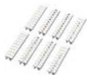
Маркировка для клеммных модулей, Полоса, белый, с маркировкой, горизонтально: L1, L2, L3, N, PE, L1, L2, L3, N, PE, Тип монтажа: Крепление в высоких пазах для табличек, для клемм шириной: 5,2 мм, Размер маркировочного поля: 5,15 x 10,5 мм
