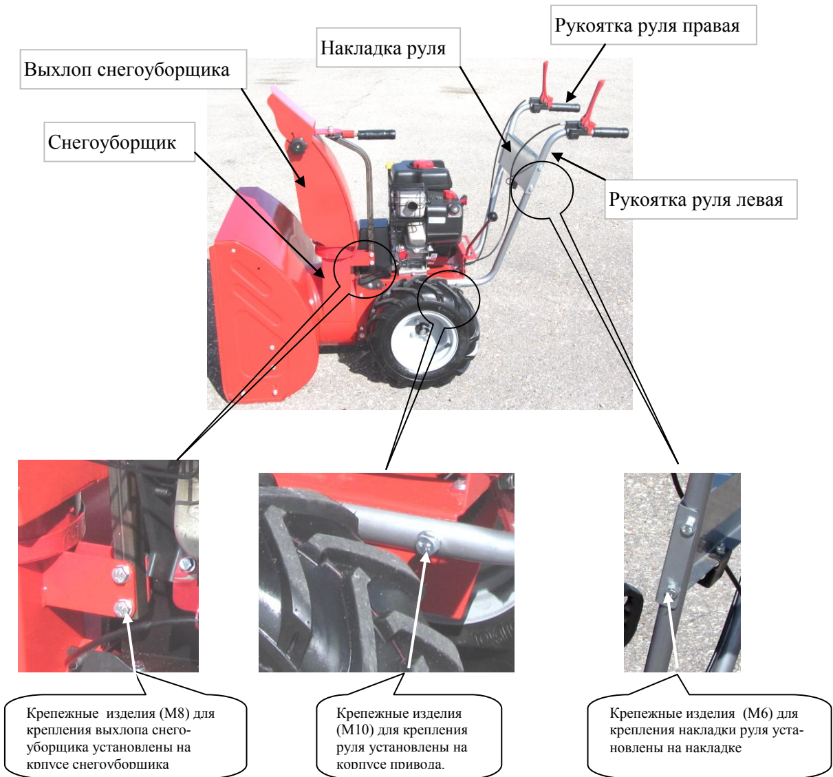
РИС.4 СБОРКА СНЕГОУБОРЩИКА ПОСЛЕ ТРАНСПОРТИРОВКИ.
