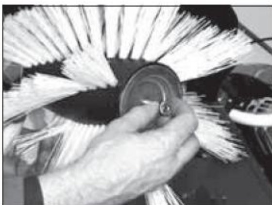
9. Теперь установите втулки на место при помощи контргайки.
