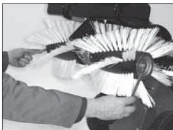
10. Затяните гайки накидными ключами.
