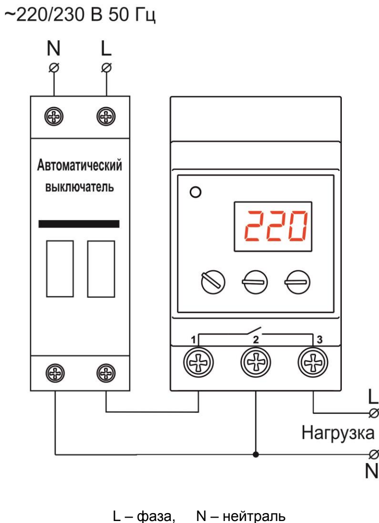
Рисунок 2 – Схема подключения изделия
