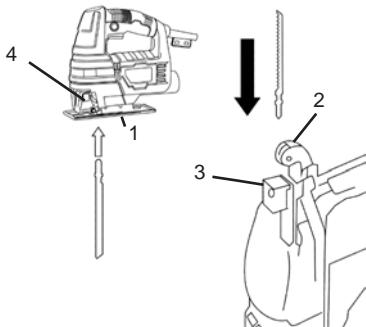
2. Держите пильное полотно так, чтобы гладкая кромка полотна входила в паз опорного ролика (2), а режущая кромка (с зубьями) соответственно должна быть направлена в противоположную сторону.
