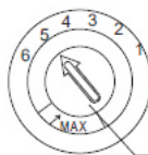
Регулировочный рычаг (ополаскиватель)
