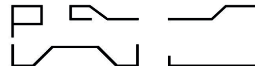
Рис. 5 Формы изгиба арматуры
