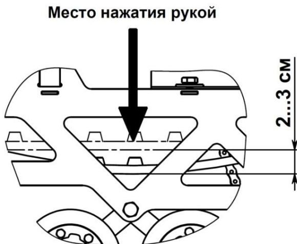
Рис.6 Проверка натяжения гусеницы
