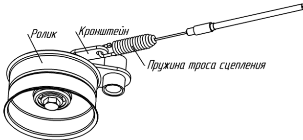
Рис.6. Схема зацепления троса сцепления с кронштейном
