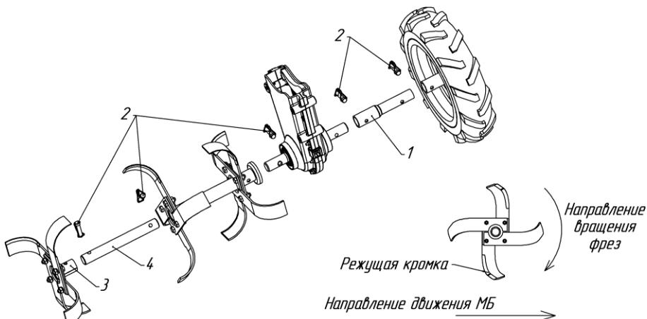
Рис.12. Установка 6 фрез-культиваторов или колес.
