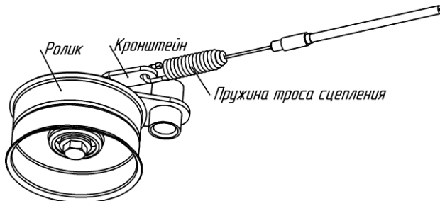
Рис.6. Схема зацепления троса сцепления с кронштейном
