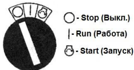
Рис.10. Замок зажигания (электростартер). Ключ в положении "O" (Выкл.).
