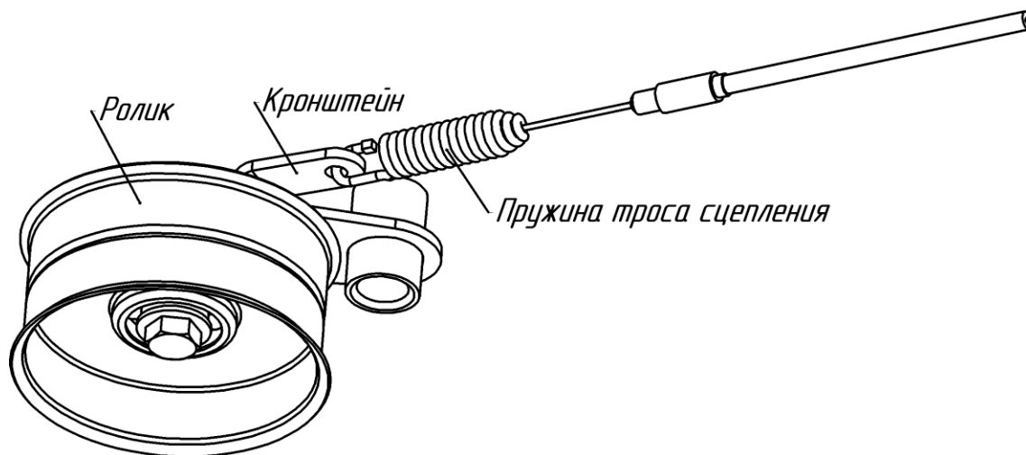
Рис.8. Схема зацепления троса сцепления с кронштейном
