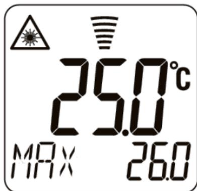
Если измеренная температура превышает температуру окружающей среды больше, чем на заданное значение верхнего предела оповещения об опасности (HAL), или оказывается ниже температуры окружающей среды на величину большую, чем заданный нижний предел оповещения об опасности (LAL), на приборе загорается красный светодиодный индикатор. В иных случаях загорается зеленый индикатор.
