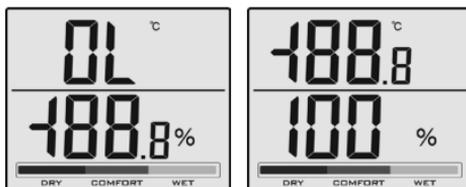
При выходе за пределы минимальных измеряемых значений: вместо измеряемой температуры отобразится -OL, а вместо влажности – 0,0%.
