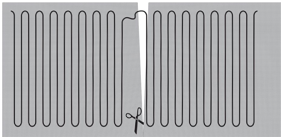
На эскизе укажите места расположения концевой и соединительной муфт, датчика температуры терморегулятора и места подключения к электрической сети. Этот эскиз поможет при поиске места повреждения кабеля при строительно-монтажных работах.
