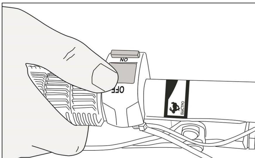
Рис. 31. Выключение зажигания
