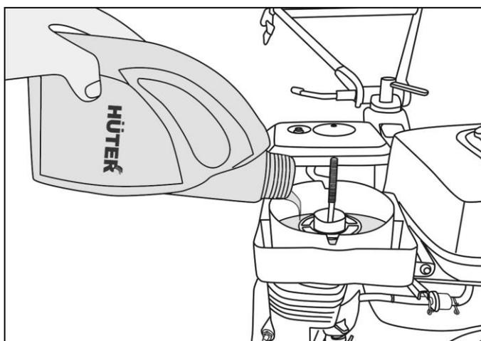
Рис. 23. Заливка масла в масляную ванну воздушного фильтра.
