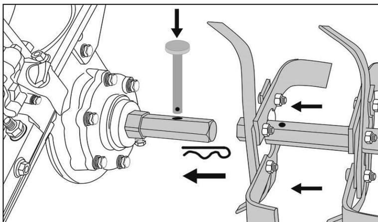
Рис. 6. Установка фрезы
