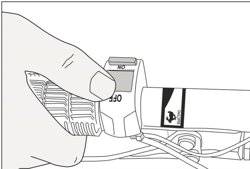
Рис. 33. Выключение зажигания
