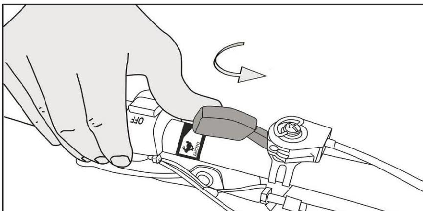
Рис. 28. Перевод ручки газа в максимальное положение
