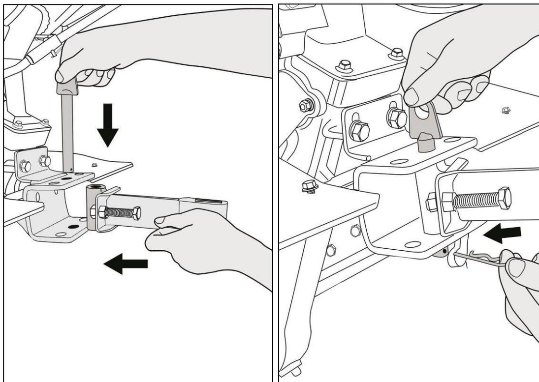
Рис.13. Установка и фиксации сцепки.
