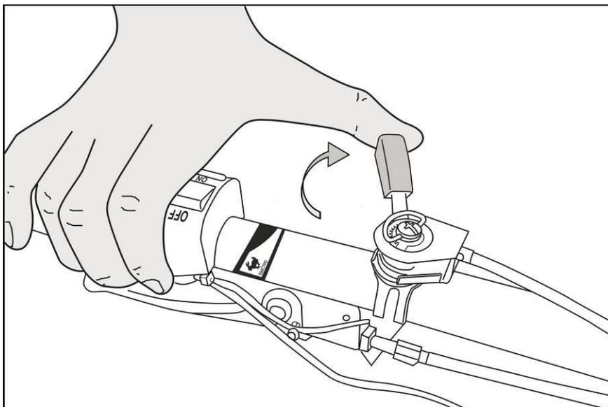
Рис. 24. Установка рычага газа в минимальное положение
