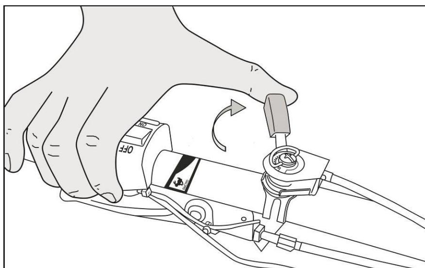
Рис. 32. Установка рычага газа в минимальное положение
