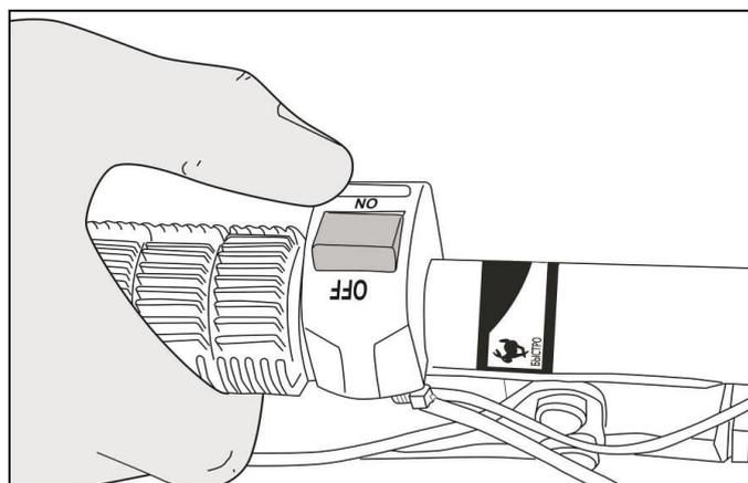
Рис. 23. Включение зажигания
