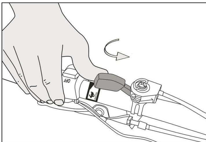
Рис. 26. Перевод ручки газа в максимальное положение
