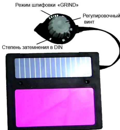
При сварочных работах светофильтр автоматически затемняется при обнаружении сварочной дуги оптическими датчиками. В этом режиме регулируется степень затемнения, время задержки и чувствительность. Степень затемнения отрегулируйте винтом 7.
